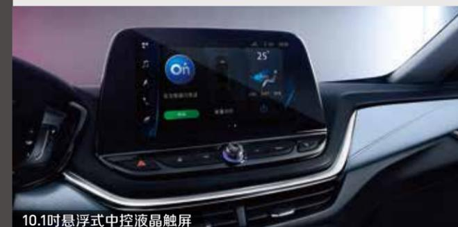
10.1吋悬浮式中控液晶触屏
